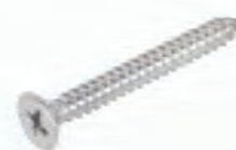
DIN7982 沉头 材质: 304 直径: ST2.2-ST6.3 长度: 4.5-100 牙别: 全牙
