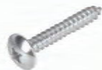
JISB1122T 大扁头自攻 材质: 304,316 直径: ST2.2-ST6.3 长度: 4.5-100 牙别: 全牙
