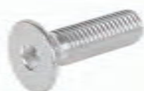
ANSI/ASMEB 18.3F 内六角沉头 材质: 304 直径: 2#-3/8 长度: 5/32-4 牙别: 全牙
