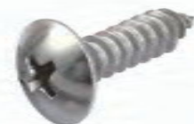
DIN968 材质: 304 直径: ST2.9-ST6.3 长度: 6.5-100 牙别: 全牙
