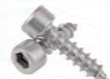
内六角自攻钉 材质: 304 直径: ST2-ST6.3 长度: 5-90 牙别: 全牙
